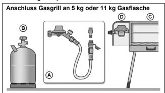
Das Anschluss-Set (A) dient als Verbindung zwischen einer Gasflasche (B) und dem anzuschließenden Gasgerät (C) mit Niederdruckregler für Gas-Kartuschen (D). Der Niederdruckregler (D) ist Bestandteil des Gasgerätes (C) und in dieses fest eingebaut.
